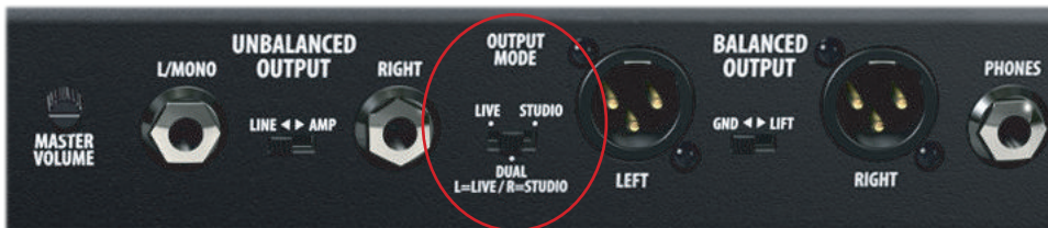
Переключатель режима вывода сигнала OUTPUT MODE
