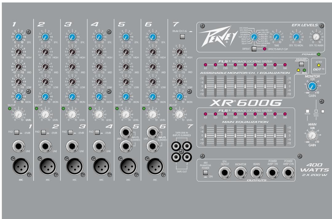
Каждый стандартный канал (1 — 6) включает в себя: отдельный микрофонный усилитель с отключаемым фантомным питанием и низким уровнем шумов, а также 3-полосный эквалайзер. Каналы 1 — 4 комплектуются, кроме этого, сбалансированными входами линейного уровня, выполненными на джеках 1/4" и переключателем аттенюатора -25 дБ, который позволяет коммутировать с пультом источники сигналов самых
