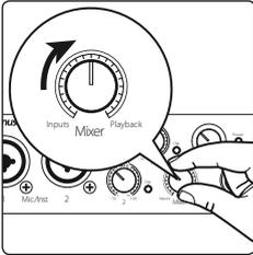
7. Поверните ручку микшера на передней панели вашего AudioBox USB96 в положение на "на 12 часов". Это позволит вам услышать, как сигнал со входов, так и сигнал воспроизводимый с компьютера. Поворачивайте регулятор вправо или влево, чтобы настроить нужный баланс громкости, между входным и воспроизводимым сигналом.
